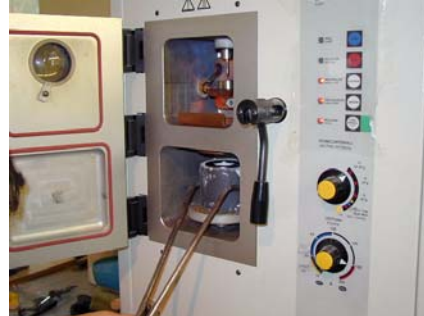
Cylindre mis en place pour la coulée
