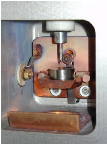
Plot de titane pur placé sous l'électrode
