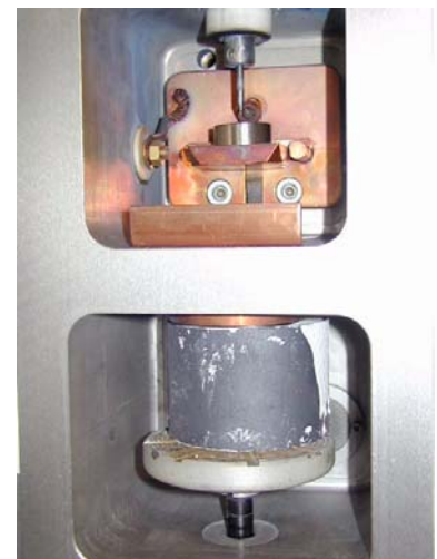
La fusion du métal se fait à l'arc électrique sous pression d'argon dans la chambre supérieure. Le cylindre contenant l'appareil à couler est dans la chambre inférieure.
